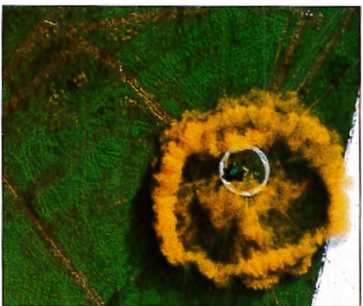
L'étude des risques chimiques passe par des essais de rejet instantané de mélange des gaz. (Cliché CEACESTA) (p. 280)
